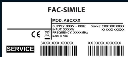
Falls der Serviceaufkleber hier fehlt, finden Sie, zur Erleichterung künftiger Servicearbeiten, die Service- und Seriennummern auf dem Typenschild am Gerät. Beide Nummern sind 12-stellig.
